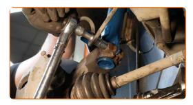
Apriete la fijación del soporte esférico. Use un vaso de impacto del n.º 15. Utilice una llave dinamométrica. Apriételo a un par de 48 Nm.
