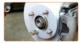
Apriete la tuerca del eje de transmisión. Use un vaso de impacto del n.º 32. Utilice una llave dinamométrica. Apriételo a un par de 290 Nm.
