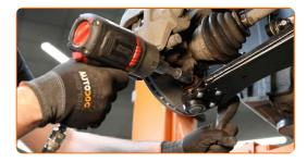
Retire el perno de sujeción.
