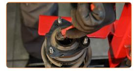
Destornille la tuerca de la varilla de la pata amortiguadora. Use Vaso HEX No. H6. Use un vaso de impacto del n.º 17. Utilice una llave de trinquete.
