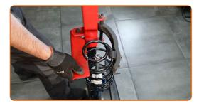
Instale la cazoleta, el guardapolvos y el tope en el amortiguador nuevo.
