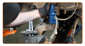
Instale el perno de sujeción.
