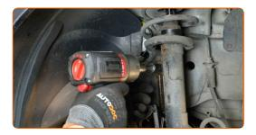
Retire el enlace estabilizador de estabilidad transversal.
