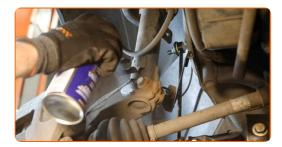
Desatornille la sujeción inferior que conecta el puntal amortiguador a la mangueta de dirección. Use un vaso de impacto del n.º 15. Utilice una llave giramachos.
