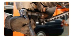
Apriete la sujeción que conecta la bieleta de barra estabilizadora al amortiguador. Use un vaso de impacto del n.º 17. Utilice una llave dinamométrica. Apriételo a un par de 48 Nm.
