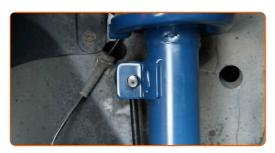
Apriete las fijaciones de la bieleta de la barra estabilizadora. Use un vaso de impacto del n.º 17. Utilice una llave de trinquete.
