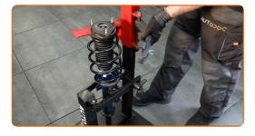
Retire el puntal amortiguador que está montado.
