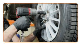
Baje el automóvil y, manteniendo el orden cruzado, apriete los pernos de fijación de las ruedas. Utilice una llave de impacto para llanta # 19. Utilice una llave dinamométrica. Apriételo a un par de 95 Nm.
