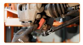
Destornille la fijación del soporte esférico del muñón de dirección. Use un vaso de impacto del n.º 15. Utilice Torx T50. Utilice una llave de trinquete.
