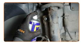
Desatornille la sujeción que conecta la bieleta de barra estabilizadora al amortiguador. Use un vaso de impacto del n.º 17. Utilice una llave de trinquete.
