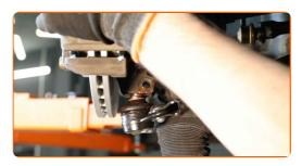
Instale el perno de sujeción.
