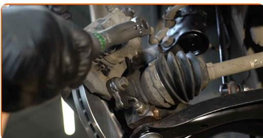
**18** Trate la superficie donde el disco del freno entra en contacto con la llanta de la rueda. Use grasa de cobre.
