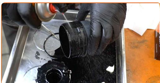
**22** Instale el nuevo filtro de aceite en el asiento de montaje de la cubierta del filtro.
