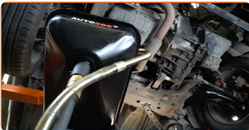
**6** Limpie el área del orificio de drenaje de la bandeja de aceite. Use un cepillo de alambre. Utilice un spray de limpieza multiuso.
