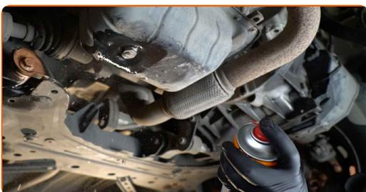
**7** Destornille el tapón de desagüe. Use un vaso de impacto del n.º 21. Utilice una llave de trinquete.
