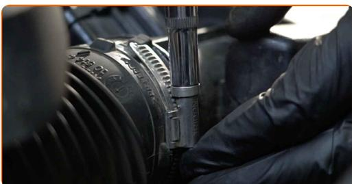
**35** Conecte la manguera de ventilación del cárter al conducto de aire.
