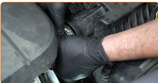
**12** Desconecte la manguera de ventilación del cárter del conducto de aire.
