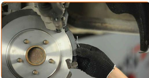
Sustitución: pastillas de freno - FORD FOCUS II Descapotable. Consejo:
