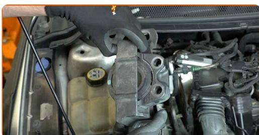
**Sustitución: soporte de motor - FORD FOCUS II Descapotable. Consejo de AUTODOC:**
