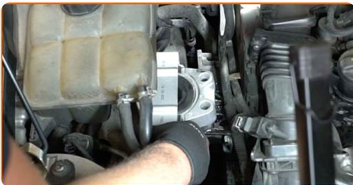
**14** Apriete los pernos de sujeción del soporte del motor. Use un vaso de impacto del n.º E11. Utilice una llave dinamométrica. Apriételo a un par de 32 Nm.
