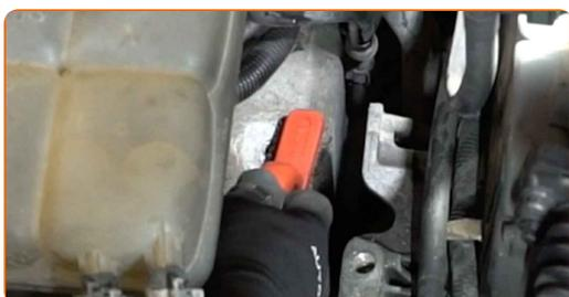
**13** Instale el soporte del motor en su asiento de montaje.
