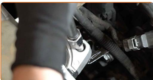
**15** Apriete las sujeciones que conectan el soporte del motor a la carrocería. Use un vaso de impacto del n.º 18. Utilice una llave dinamométrica. Apriételo a un par de 65 Nm.
