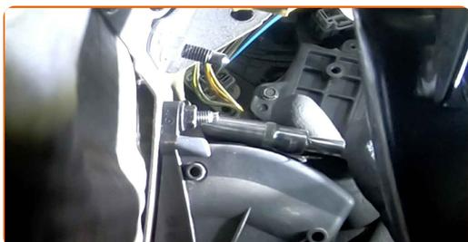
**5** Separe el conector del pedal del acelerador.
