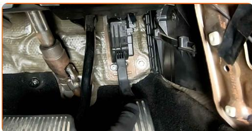
**15** Vuelva a colocar el pedal del acelerador en su posición inicial y atornille su sujeción. Use un vaso de impacto del n.º 10. Utilice una llave de trinquete.
