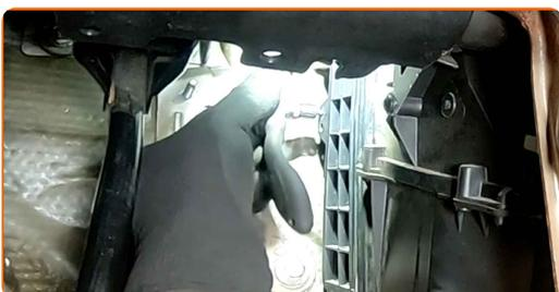
**13** Conecte el conector del pedal del acelerador.
