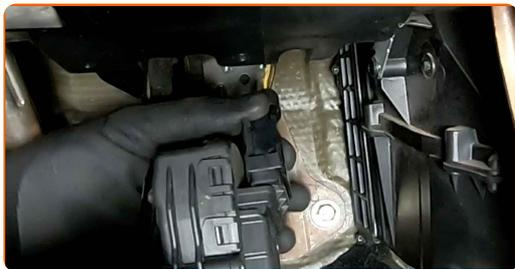
**14** Vuelva a instalar el pedal del acelerador.
