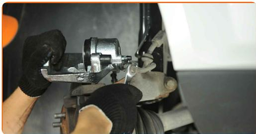
**22** Retire la abrazadera de la manguera del freno.
