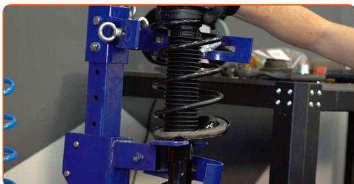
**38** Limpie los asientos de montaje del amortiguador. Use un cepillo de alambre. Use el aerosol WD-40.
