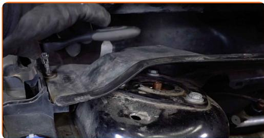
**53** Instale las sujeciones de la rejilla de plástico del capó del limpiaparabrisas.
