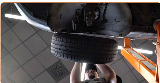
**17** Desconecte los cables eléctricos y el latiguillo de freno del soporte en la pata amortiguadora.
