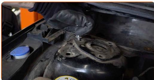
Sustitución: copelas del amortiguador - FORD Focus II Hatchback (DA\_, HCP, DP). Los expertos de AUTODOC recomiendan:
