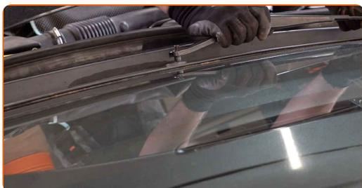
**55** Apriete las fijaciones de los brazos del limpiaparabrisas. Use un vaso de impacto del n.º 15. Utilice una llave dinamométrica. Apriételo a un par de 10 Nm.
