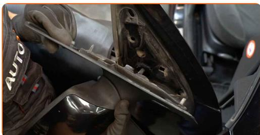
**8** Limpie el asiento de montaje del espejo retrovisor. Use el aerosol WD-40.
