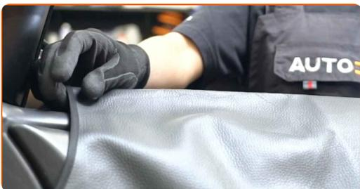
3 Retire la cubierta del espejo retrovisor lateral. Utilice una herramienta de recorte de plástico.
