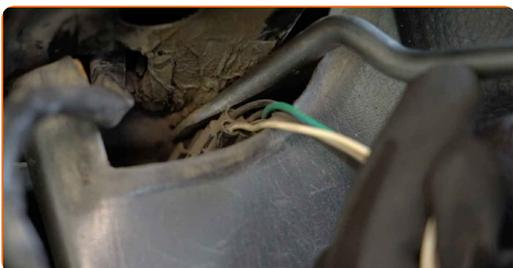
**5** Separe el conector del ajustador del espejo de la puerta.
