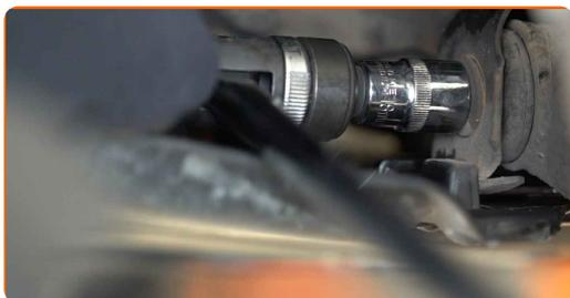
**11** Retire la sujeción delantera del brazo de control. Use una palanca. Utilice un martillo.
