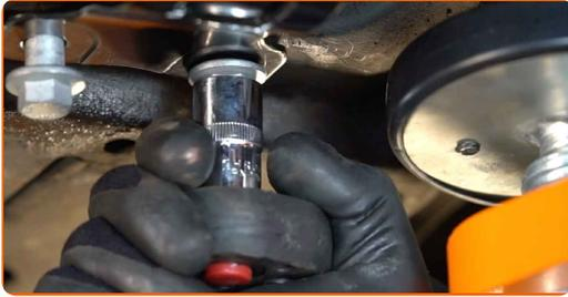
**23** Atornille la fijación delantera de la palanca. Use un vaso de impacto del n.º 18. Utilice una llave dinamométrica. Apriételo a un par de 175 Nm.
