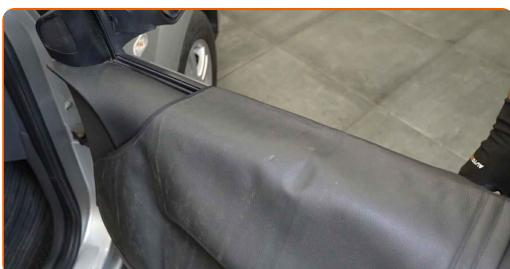
4 Retire la cubierta del espejo retrovisor lateral. Utilice una herramienta de recorte de plástico.
