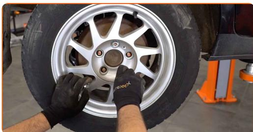
**30** Baje el automóvil y, manteniendo el orden cruzado, apriete los pernos de fijación de las ruedas. Utilice una llave dinamométrica. Apriételo a un par de 110 Nm.
