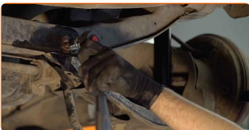
**17** Instale la nueva palanca de suspensión. Instale las sujeciones del brazo de control.
