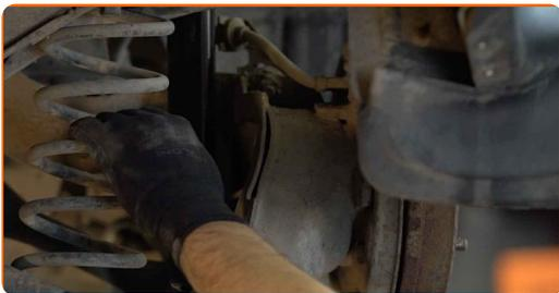
**16** Destornille la fijación de la palanca inferior. Retire el perno de sujeción.
