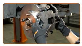
20 Instale el resorte de fijación del cáliper de freno.
