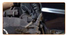
Limpie las sujeciones de la pinza del freno. Utilice un cepillo de limpieza de nylon. Use un limpiador de frenos.
