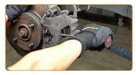
Tire a un lado del muelle de retención de la pinza de freno. Use una palanca.
