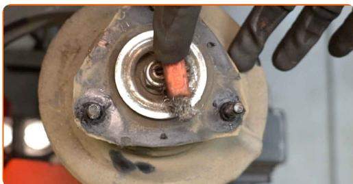
**36** Destornille la tuerca de la varilla de la pata amortiguadora. Use un vaso de impacto del n.º 19. Use Vaso HEX No. H6. Utilice una llave de trinquete.
