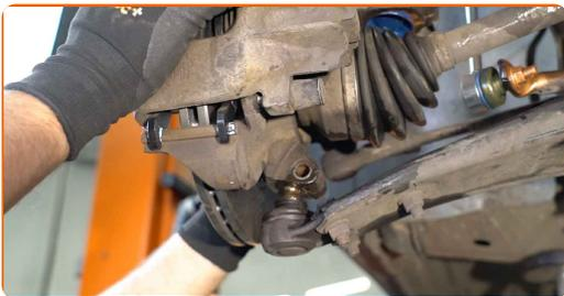
**64** Instale el perno de sujeción.
