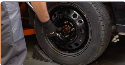
**10** Levante la parte delantera del automóvil y fije la posición sobre los pedestales.
