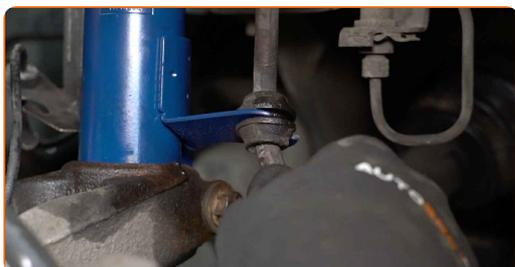
**75** Trate las sujeciones del amortiguador. Use grasa de cobre.
