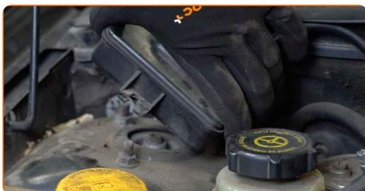
**4** Limpie las fijaciones del soporte de montaje superior del amortiguador. Use un cepillo de alambre. Use el aerosol WD-40.
