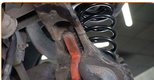
**27** Instale la barra del estabilizador de estabilidad transversal.
