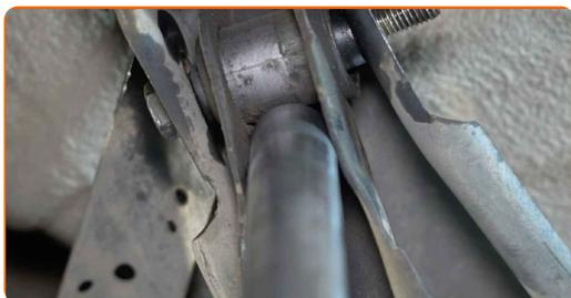
**13** Retire el perno de sujeción.
