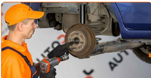
**9** Destornille la fijación del cojinete del cubo. Use un vaso de impacto del n.º 30.
