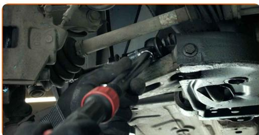
**17** Apriete la sujeción que conecta la bieleta de barra estabilizadora al amortiguador. Use un vaso de impacto del n.º 17. Utilice una llave dinamométrica. Apriételo a un par de 48 Nm.
