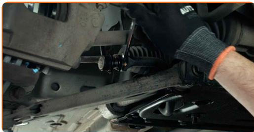
**8** Desatornille la sujeción que conecta la bieleta de barra estabilizadora al amortiguador. Use un vaso de impacto del n.º 17. Utilice una llave de trinquete.
