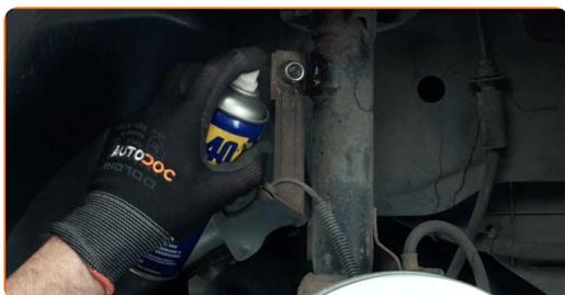
**7** Desatornille la sujeción que conecta la bieleta a la barra estabilizadora. Usa una llave mixta del n.º 17 (2 piezas).
