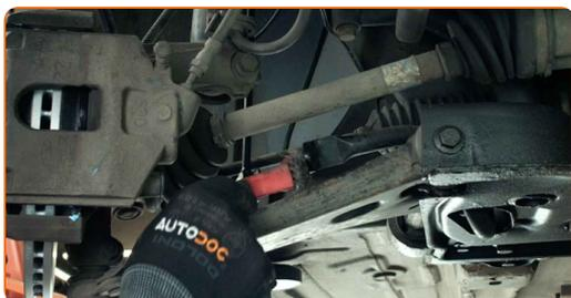
**14** Instale la barra del estabilizador de estabilidad transversal.
