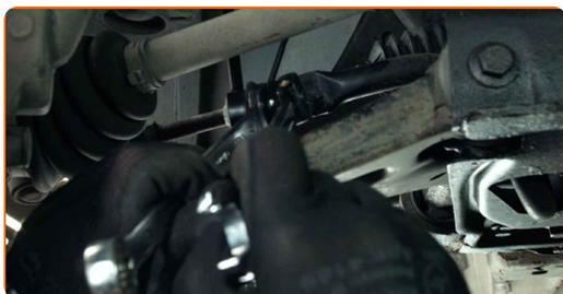
**16** Apriete la sujeción que conecta la bieleta a la barra estabilizadora. Use un vaso de impacto del n.º 17. Utilice una llave dinamométrica. Apriételo a un par de 55 Nm.
