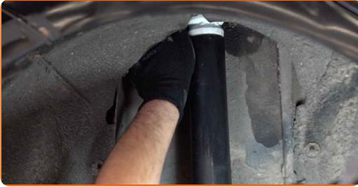
21 Atornille la sujeción del soporte del amortiguador. Use un vaso de impacto del n.º 10. Utilice una llave de trinquete.
