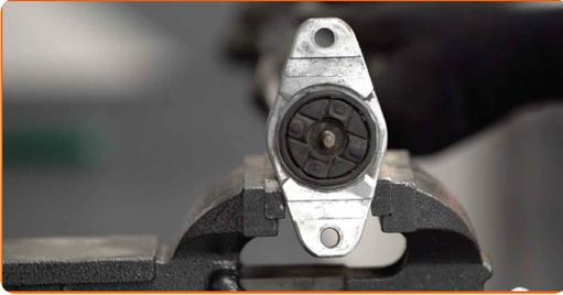
**17** Atornille la fijación superior de la varilla del amortiguador. Usa una llave mixta del n.º 13. Use un vaso de impacto del n.º 13. Use una llave ajustable. Utilice una llave dinamométrica. Apriételo a un par de 25 Nm.
