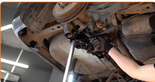
24 Atornille la fijación de la cazoleta del amortiguador. Use un vaso de impacto del n.º 10. Utilice una llave dinamométrica. Apriételo a un par de 25 Nm.
