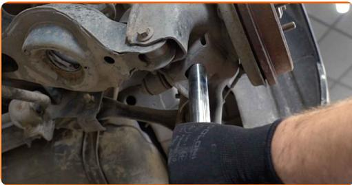
23 Apriete la fijación inferior del amortiguador. Use un vaso de impacto del n.º 16. Utilice una llave dinamométrica. Apriételo a un par de 103 Nm.
