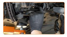
Desconecte el soporte esférico del muñón de dirección.
