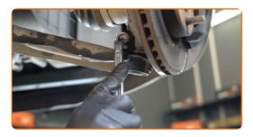
Retire el perno de sujeción.
