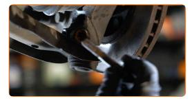
Destornille la fijación delantera de la palanca. Use un vaso de impacto del n.º 15. Utilice una llave giramachos.
