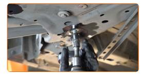
Desatornille la sujeción trasera que conecta el brazo de control al subchasis. Use un vaso de impacto del n.º 13. Utilice una llave giramachos.
