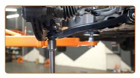
21 Instale el perno de sujeción.
