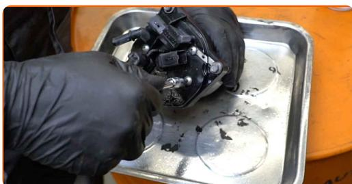
**13** Retire la cubierta de la carcasa del filtro de combustible.
