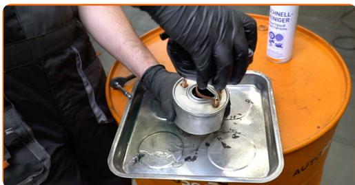
**14** Limpie la carcasa del filtro de combustible y la cubierta. Utilice un spray de limpieza multiuso.
