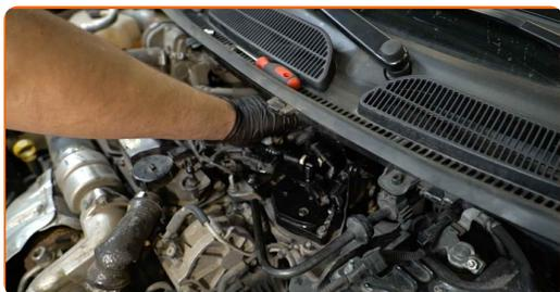
**23** Conecte las líneas de admisión del combustible al filtro de combustible y cierre las grapas de fijación.
