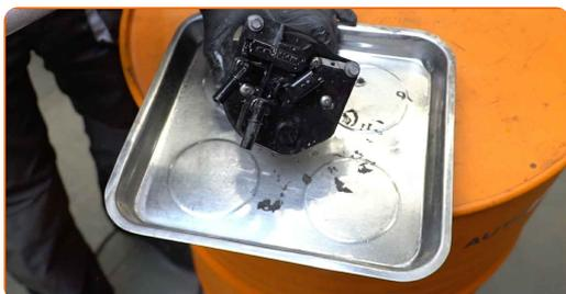
**12** Desatornille las sujeciones de la tapa de la carcasa del filtro de combustible. Utilice Torx T15. Utilice una llave de trinquete.
