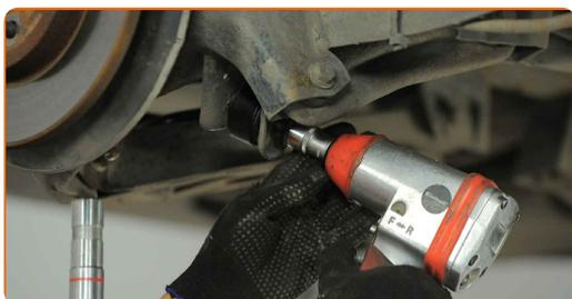
**16** Apriete la fijación superior del amortiguador. Usa una llave mixta del n.º 18. Use un vaso de impacto del n.º 15. Utilice una llave dinamométrica. Apriételo a un par de 84 Nm.
