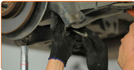
**15** Apriete la fijación inferior del amortiguador. Use un vaso de impacto del n.º 18. Utilice una llave dinamométrica. Apriételo a un par de 120 Nm.
