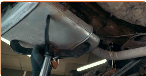
**12** Desenrosque las sujeciones del protector térmico del escape. Use un vaso de impacto del n.º 10. Utilice una llave de trinquete.
