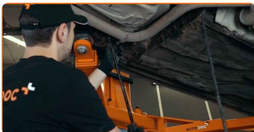
**9** Apoye el silenciador. Utilice un gato de transmisión hidráulica.
