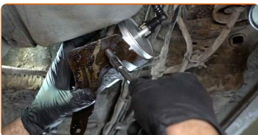
**19** Atornille los pernos de sujeción del soporte del filtro de combustible. Use un vaso de impacto del n.º 10. Utilice una llave de trinquete.
