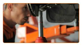
Apriete la sujeción delantera que conecta el brazo de control al subchasis. Use un vaso de impacto del n.º 15. Utilice una llave dinamométrica. Apriételo a un par de 80 Nm.+60°
