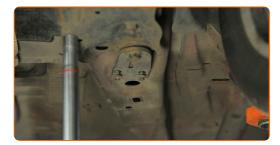
Apriete la sujeción del soporte que conecta el brazo de control a la carrocería del automóvil. Use un vaso de impacto del n.º 21. Utilice una llave dinamométrica. Respete el par de apriete recomendado.
