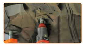
Apriete la sujeción del soporte que conecta el brazo de control a la carrocería del automóvil. Use un vaso de impacto del n.º 10. Utilice una llave dinamométrica. Respete el par de apriete recomendado.
