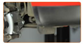
Atornille la fijación delantera de la palanca. Use un vaso de impacto del n.º 15. Utilice una llave de trinquete.
