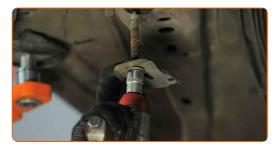
Desatornille la sujeción del soporte que conecta el brazo de control a la carroceria del coche. Use un vaso de impacto del n.º 21. Utilice una llave de trinquete.
