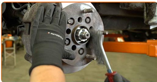
**28** Trate la superficie en la que el cubo de rueda entra en contacto con la llanta. Utilice grasa cerámica.
