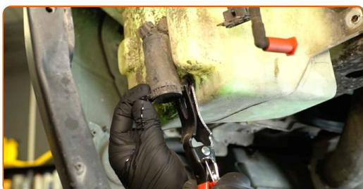
**17** Retire la junta de la bomba del limpiaparabrisas. Utilice una palanca de montaje.
