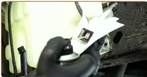
**23** Una el conector de la bomba del limpiaparabrisas.
