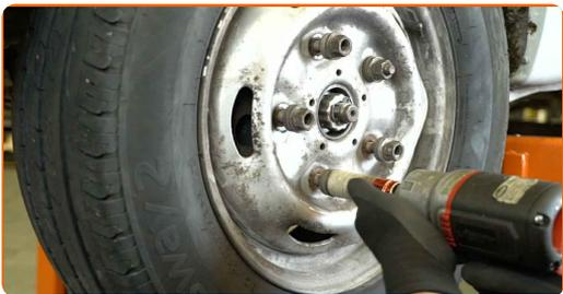
**31** Baje el coche y apriete las tuercas de la rueda siguiendo un orden entrecruzado. Utilice un vaso de impacto para ruedas de 21 mm. Utilice una llave dinamométrica. Par de apriete: 200 N·m.
