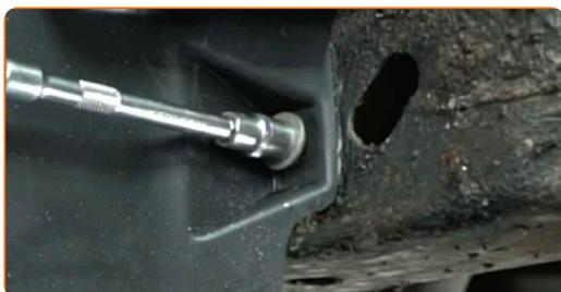
**26** Enrosque el perno de sujeción de la tapa del depósito del limpiaparabrisas. Utilice una llave de vaso de 10 mm. Utilice una llave de carraca.
