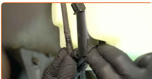
**22** Trate el conector de la bomba del limpiaparabrisas. Utilice un spray para contactos eléctricos.
