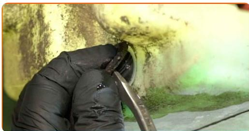
**18** Limpie el asiento de montaje de la bomba del limpiaparabrisas. Utilice un spray limpiador multiusos.
