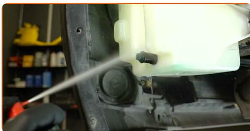
**19** Instale una nueva junta de la bomba del limpiaparabrisas.
