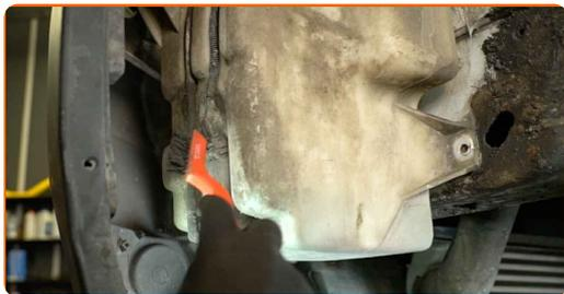
**13** Separe el conector de la bomba del limpiaparabrisas. Utilice una palanca de montaje.
