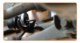
Desatornille la sujeción que conecta la bieleta de barra estabilizadora al amortiguador. Use un vaso de impacto del n.º 15. Utilice una llave de trinquete.
