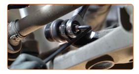
Apriete la sujeción que conecta la bieleta de barra estabilizadora al amortiguador. Use un vaso de impacto del n.º 15. Utilice una llave dinamométrica. Apriételo a un par de 48 Nm.
