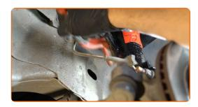
Instale la barra nueva, atornille las fijaciones. Usa una llave mixta del n.º 15. Use Vaso HEX No. H5. Utilice una llave de trinquete.
