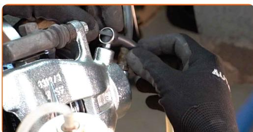
**34** Afloje el tornillo de purgado de frenos. Usa una llave mixta del n.º 9.
