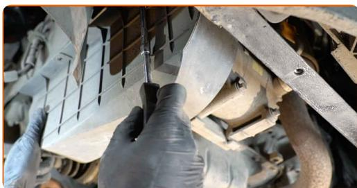
**16** Apriete los sujetadores de la cubierta inferior del cárter de aceite. Utilice Torx T30. Utilice una llave de trinquete.
