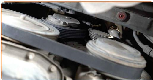
**12** Vuelva a colocar la polea tensora en su posición inicial. Usa una llave mixta del n.º 15.
