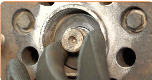
**69** Enrosque la tuerca del eje. Utilice una llave de vaso de 36 mm. Utilice una llave de carraca.
