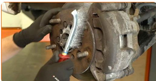
**81** Trate la superficie en la que el cubo de rueda entra en contacto con la llanta. Utilice grasa cerámica.
