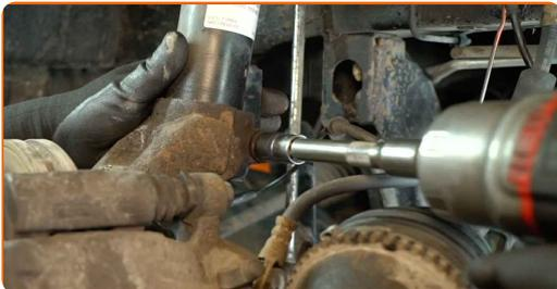
**41** Retire el perno de sujeción.
