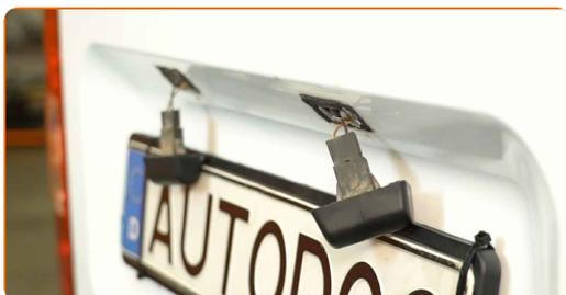
**4** Desconecte el conector de la luz para la placa de matrícula.
