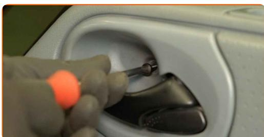
**14** Apriete las sujeciones del panel de la puerta. Utilice un destornillador Phillips.
