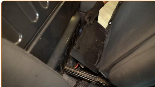
**4** Desenrosque la sujeción del borne negativo de la batería. Utilice una llave de vaso de 10 mm. Utilice una llave de carraca.
