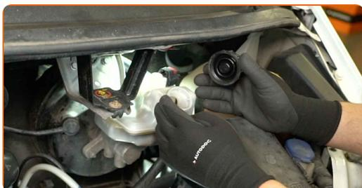
33 Apriete el tapón del depósito del líquido de frenos.
