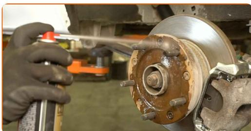
26 Trate la superficie en la que el cubo de rueda entra en contacto con la llanta. Utilice grasa cerámica.
