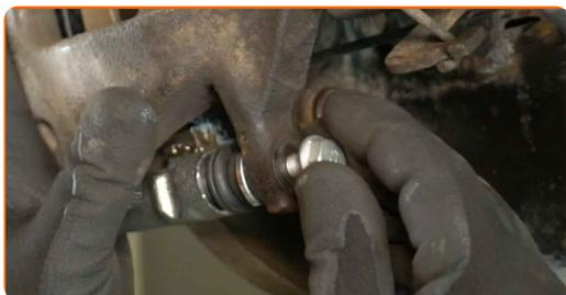
24 Apriete las sujeciones de la pinza de freno. Utilice una llave combinada de 18 mm. Utilice una llave de vaso de 13 mm. Utilice una llave dinamométrica. Par de apriete: 31 N·m.
