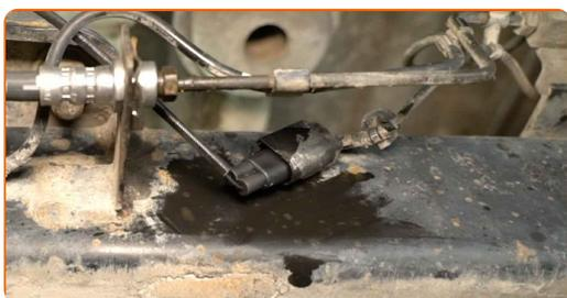
20 Fije de forma segura el cable del sensor de desgaste de las pastillas de freno.
