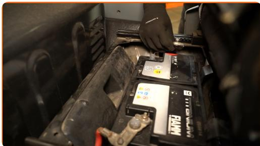
6 Desenrosque la sujeción del borne positivo de la batería. Utilice una llave de vaso de 10 mm. Utilice una llave de carraca.
