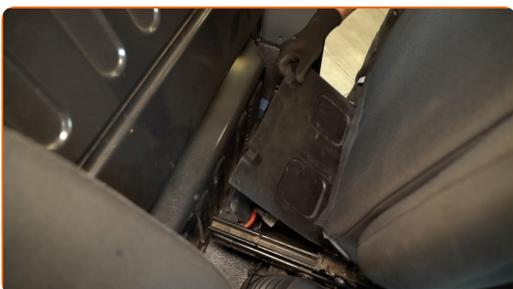
4 Desenrosque la sujeción del borne negativo de la batería. Utilice una llave de vaso de 10 mm. Utilice una llave de carraca.
