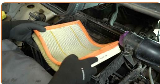
**9** Limpie la cubierta y la carcasa del filtro de aire.
