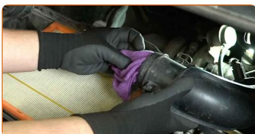
**8** Retire el elemento filtrante de la carcasa del filtro.
