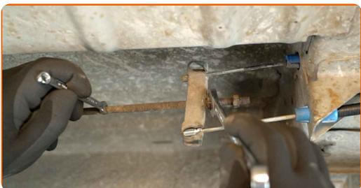
**34** Apriete la tuerca de bloqueo sobre la tuerca de ajuste. Utilice dos llaves combinadas de 13 mm.
