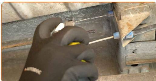
8 Desenrosque la tuerca de bloqueo y afloje la tuerca de ajuste del cable del freno de mano. Utilice dos llaves combinadas de 13 mm.
