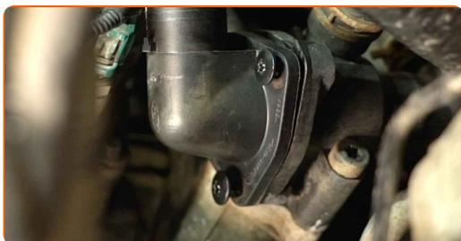
20 Apriete las sujeciones de la cubierta de la carcasa del termostato. Utilice una punta Torx T30. Utilice una extensión de llave de vaso para junta cardán. Utilice una llave dinamométrica. Par de apriete: 10 N·m.
