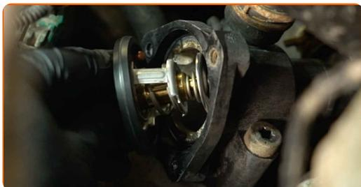
18 Instale la cubierta de la carcasa del termostato.
