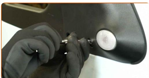
**13** Instale las cubiertas de los elementos de sujeción del espejo retrovisor lateral.
