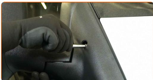
**12** Atornille los elementos de sujeción del espejo retrovisor lateral. Utilice una llave de vaso de 8 mm. Utilice una llave de carraca.
