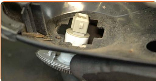
**8** Instale el repetidor del intermitente en un nuevo espejo retrovisor lateral.
