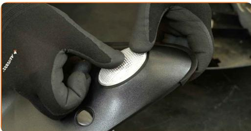
**9** Vuelva a unir el conector al repetidor del intermitente.
