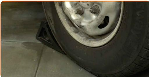
**2** Afloje las tuercas de las ruedas delanteras. Utilice un vaso de impacto para ruedas de 21 mm. Utilice una llave giramachos con mango en T.
