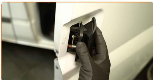
**6** Apriete la sujeción de la manilla de la puerta. Utilice una llave de vaso de 10 mm. Utilice una llave dinamométrica. Par de apriete: 10 N·m.
