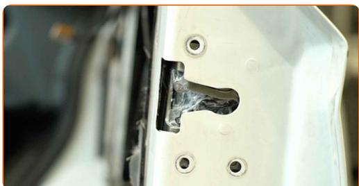
**20** Instale los tornillos de sujeción.
