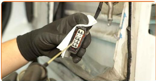
**17** Una el cable del pestillo de la puerta a una nueva cerradura de la puerta.
