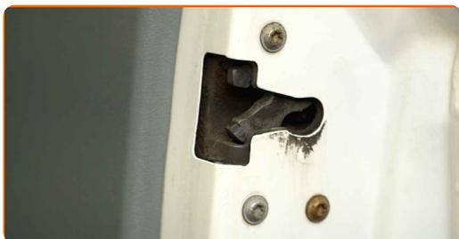
**2** Desenrosque las sujeciones del panel de la puerta. Utilice un destornillador Phillips.
