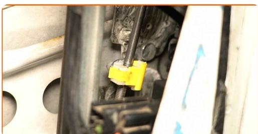
**26** Trate el conector del interruptor del elevallunas eléctrico. Utilice un spray para contactos eléctricos.
