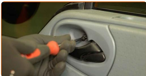
**31** Apriete las sujeciones del panel de la puerta. Utilice un destornillador Phillips.
