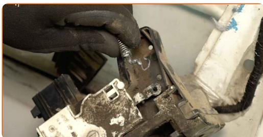
**16** Trate el conector de la cerradura de la puerta. Utilice un spray para contactos eléctricos.
