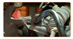
Limpie los asientos de montaje de los casquillos de la barra estabilizadora. Utilice un cepillo de alambre. Utilice un spray limpiador multiusos.
