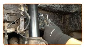
Limpie las sujeciones del soporte de uno de los casquillos de la barra estabilizadora. Utilice un cepillo de alambre. Utilice el spray WD-40.
