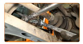
Apriete la sujeción que conecta la bieleta de la barra estabilizadora al puntal de suspensión. Utilice una llave combinada de 20 mm. Utilice una llave de vaso de 17 mm. Utilice una llave dinamométrica. Par de apriete: 55 N·m.
