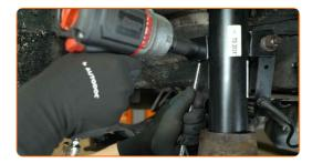
Retire la bieleta de la barra estabilizadora.
