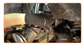
Apriete la sujeción que conecta la bieleta de la barra estabilizadora a la barra estabilizadora. Utilice una llave combinada de 20 mm. Utilice una llave de vaso de 17 mm. Utilice una llave dinamométrica. Par de apriete: 55 N·m.
