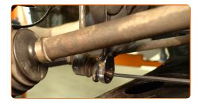
Desenrosque la sujeción que conecta la bieleta de la barra estabilizadora al puntal de suspensión. Utilice una llave de vaso de 19 mm. Utilice una llave de carraca.
