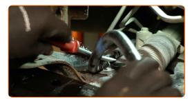
Instale un casquillo de barra estabilizadora nuevo en un lado del eje.
