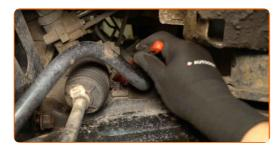
Desenrosque las sujeciones del soporte del casquillo de la barra estabilizadora. Utilice una llave de vaso de 10 mm. Utilice una llave de carraca.
