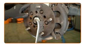
Trate la superficie en la que el cubo de rueda entra en contacto con la llanta. Utilice grasa cerámica.
