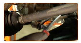
Desenrosque la sujeción que conecta la bieleta de la barra estabilizadora a la barra estabilizadora. Utilice una llave combinada de 19 mm. Utilice una llave Allen H5 para fijar de forma segura el perno esférico. Utilice una llave de carraca.
