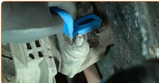
**4** Desenrosque los elementos de sujeción inferiores del soporte del motor. Utilice una llave de vaso de 13 mm. Utilice una llave de trinquete.
