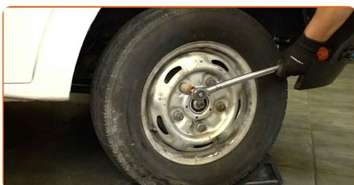
**72** Apriete la tuerca del eje. Utilice una llave de vaso de 36 mm. Utilice una llave dinamométrica. Par de apriete: 320 N·m.
