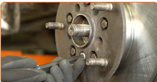
49 Apriete los pernos de sujeción del rodamiento de rueda. Utilice una punta Torx T50. Utilice una llave dinamométrica. Par de apriete: 53 N·m.
