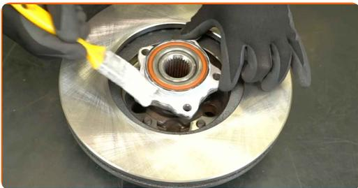
47 Instale el cubo de rueda junto con el disco de freno.
