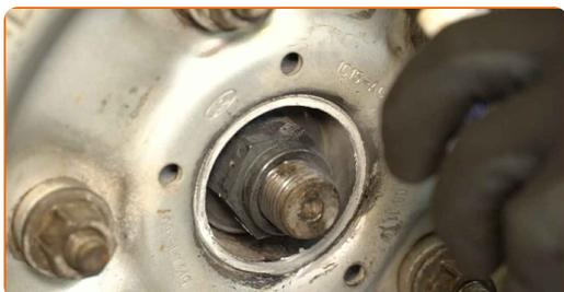
9 Afloje la tuerca del eje. Utilice una llave de vaso de 36 mm. Utilice una llave giramachos con mango en T.
