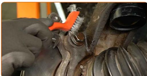
**27** Desenrosque las sujeciones del soporte de la pinza de freno. Utilice una llave de vaso de 18 mm. Utilice una llave giramachos con mango en T.
