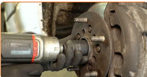
14 Retire la arandela del eje. Utilice una herramienta de recogida magnética telescópica.
