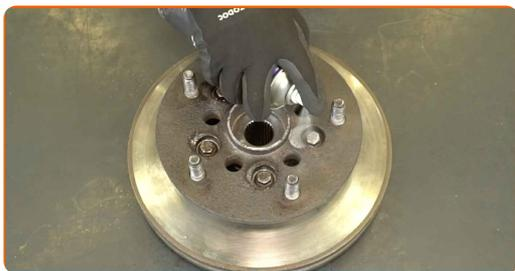
**39** Desenrosque las sujeciones del disco de freno. Utilice una llave de vaso de 13 mm. Utilice una llave de carraca.
