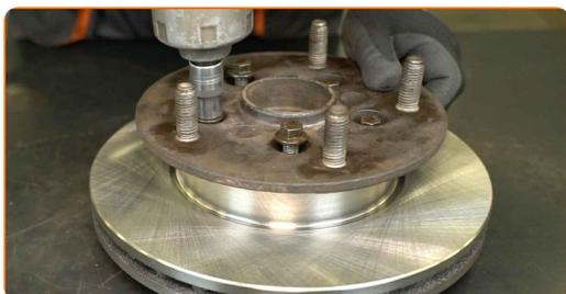
46 Trate la superficie de montaje en el rodamiento de rueda. Utilice grasa cerámica.
