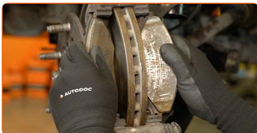
**26** Limpie las sujeciones del soporte de la pinza de freno. Utilice un cepillo de alambre. Utilice el spray WD-40.
