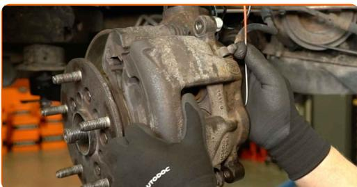
**Sustitución: sensor de desgaste de pastillas de frenos - FORD Transit Mk6 Bus (V347, V348). Consejo:**
