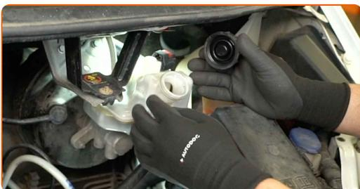
31 Apriete el tapón del depósito del líquido de frenos.
