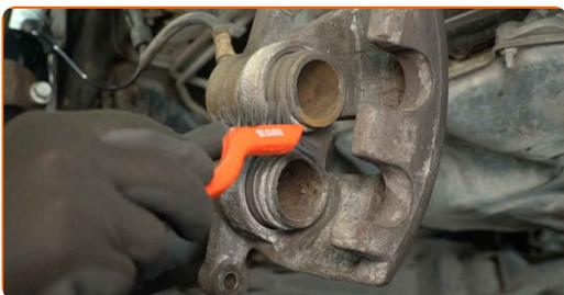
**16** Retraiga los pistones de la pinza de freno. Utilice una herramienta de reposición de pistones de pinzas de freno.
