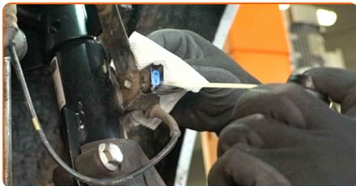
18 Una el conector del nuevo sensor de desgaste de las pastillas de freno.
