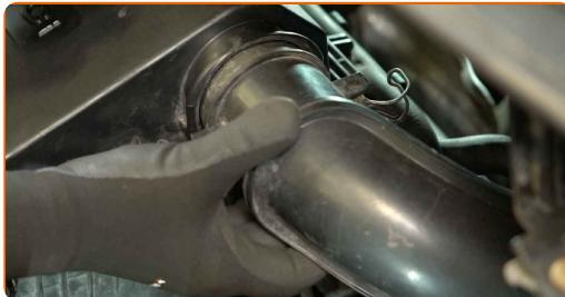
**5** Desenganche los clips de la cubierta del filtro de aire.
