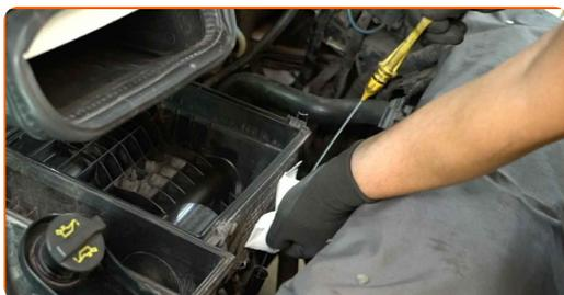
**13** Tape el orificio de la varilla de nivel de aceite con una toalla de papel para evitar que entre suciedad en el sistema.
