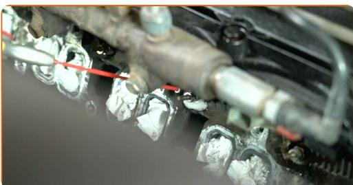
**36** Desenrosque las bujías de precalentamiento. Utilice una llave de vaso para bujías de precalentamiento de 10 mm. Utilice una llave dinamométrica.
