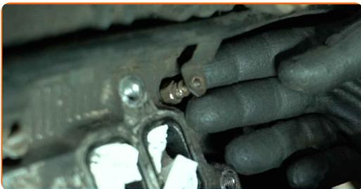
**34** Retire los terminales y aparte el cable de la bujía de precalentamiento.
