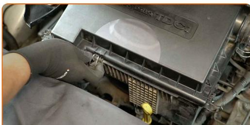
**6** Retire la cubierta del filtro de aire.
