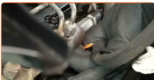
**62** Conecte el conector del sensor de presión de combustible.
