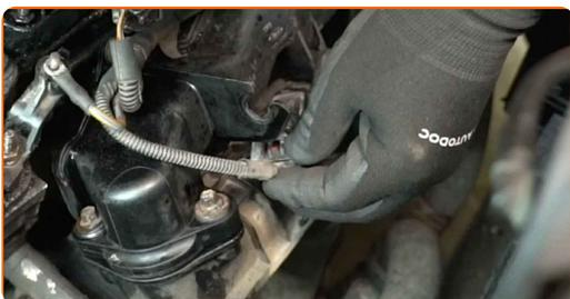
**64** Conecte el terminal del cable de alimentación de las bujías de precalentamiento y enrosque la tuerca que lo fija de forma segura. Utilice una llave de vaso de 8 mm. Utilice una llave de carraca.
