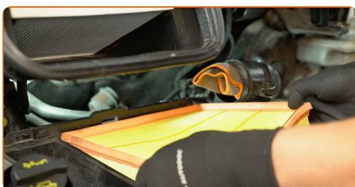
**9** Desenrosque las sujeciones de la carcasa del filtro de aire. Utilice una llave de vaso de 10 mm. Utilice una llave de carraca.
