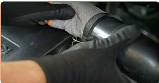
**74** Conecte la manguera de admisión de aire a la carcasa del filtro de aire.
