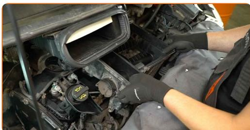
**15** Limpie los conectores de los sensores de presión de combustible, MAP y de posición del árbol de levas. Utilice un spray limpiador multiusos.
