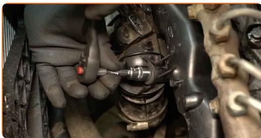
**55** Instale las sujeciones del soporte del tubo de la varilla de nivel de aceite.
