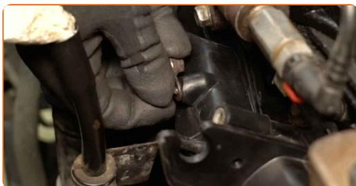
**56** Atornille las sujeciones del soporte del tubo de la varilla de nivel de aceite. Utilice una llave de vaso de 8 mm. Utilice una llave de carraca.
