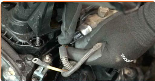
**63** Conecte el conector del sensor MAP.
