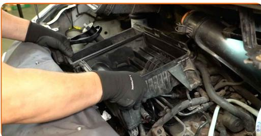
**67** Fije de forma segura las mangueras de goma en la carcasa del filtro de aire.
