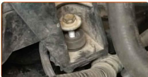
**69** Atornille las sujeciones de la carcasa del filtro de aire. Utilice una llave de vaso de 10 mm. Utilice una llave de carraca.
