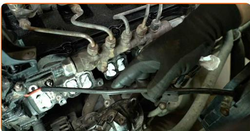
**35** Limpie el área alrededor de los pozos de las bujías de precalentamiento para eliminar cualquier resto de suciedad, polvo o residuos. Utilice un cepillo de alambre. Utilice el spray WD-40.
