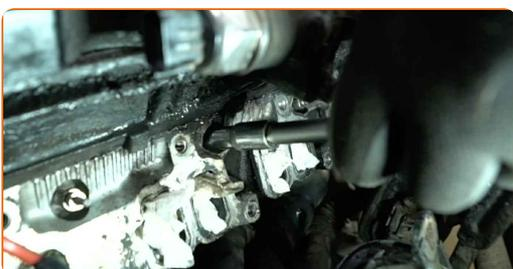
Sustitución: bujías de precalentamiento - FORD Transit Mk6 Bus (V347, V348).
