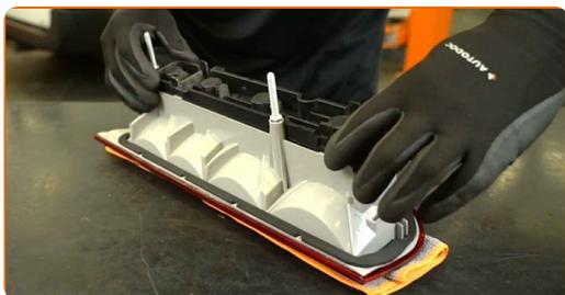
**7** Trate el conector de la luz trasera. Utilice un spray para contactos eléctricos.
