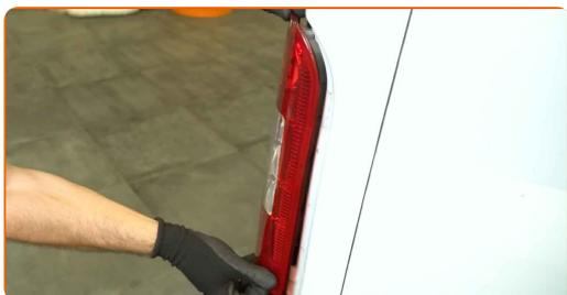
**10** Apriete los elementos de sujeción que conectan la luz trasera con la carrocería del coche.
