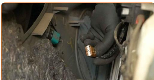
**7** Trate el conector del interruptor del elevallunas eléctrico. Utilice un spray para contactos eléctricos.
