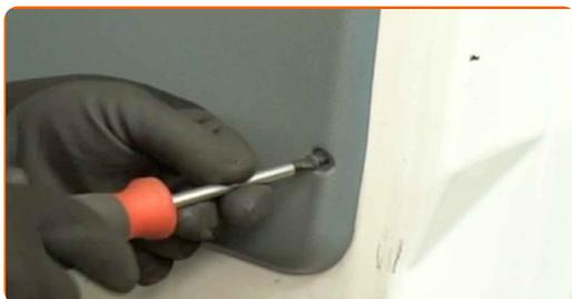
**5** Separe el panel de la puerta. Utilice una herramienta para desmontar molduras de plástico.
