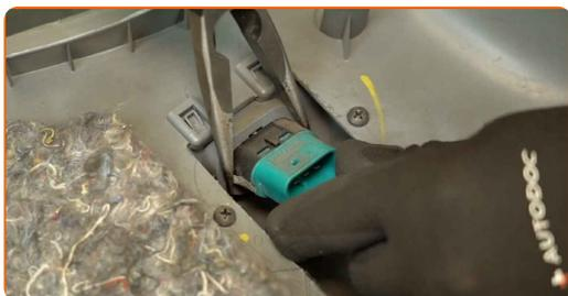
**9** Instale el interruptor del elevallunas eléctrico nuevo en el panel de la puerta.
